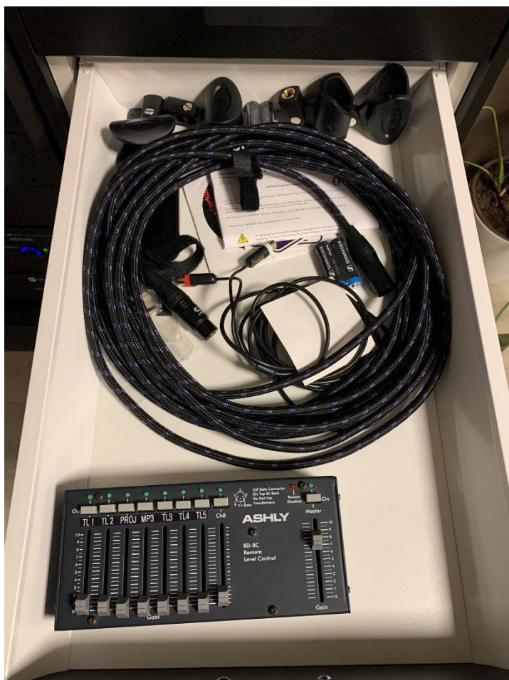
Skuff med kontrollenhet for lyd og tilhørende kabler
