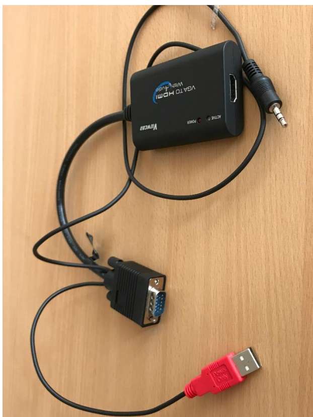
Standard VGA-port (analog skjermutgang). For lyd kobles separat mini-jack til PC'ens høyttalerutgang.
