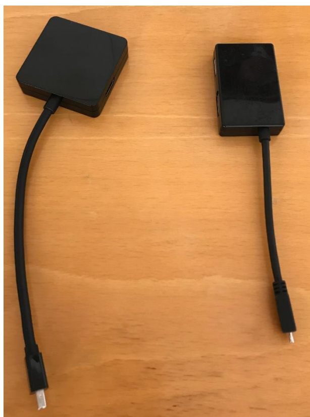
Til venstre: Mini-displayport (Mac, tablet). Til høyre i bildet: Mini-USB
